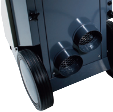
CDT 30 S et CDT 40 S sont équipés d'un corps de chauffe d'1 kW et d'un ventilateur avec une pression stable permettant le raccordement de 2 gaines flexibles diamètre 100 mm et de 5m de longueur maximum chacune.
